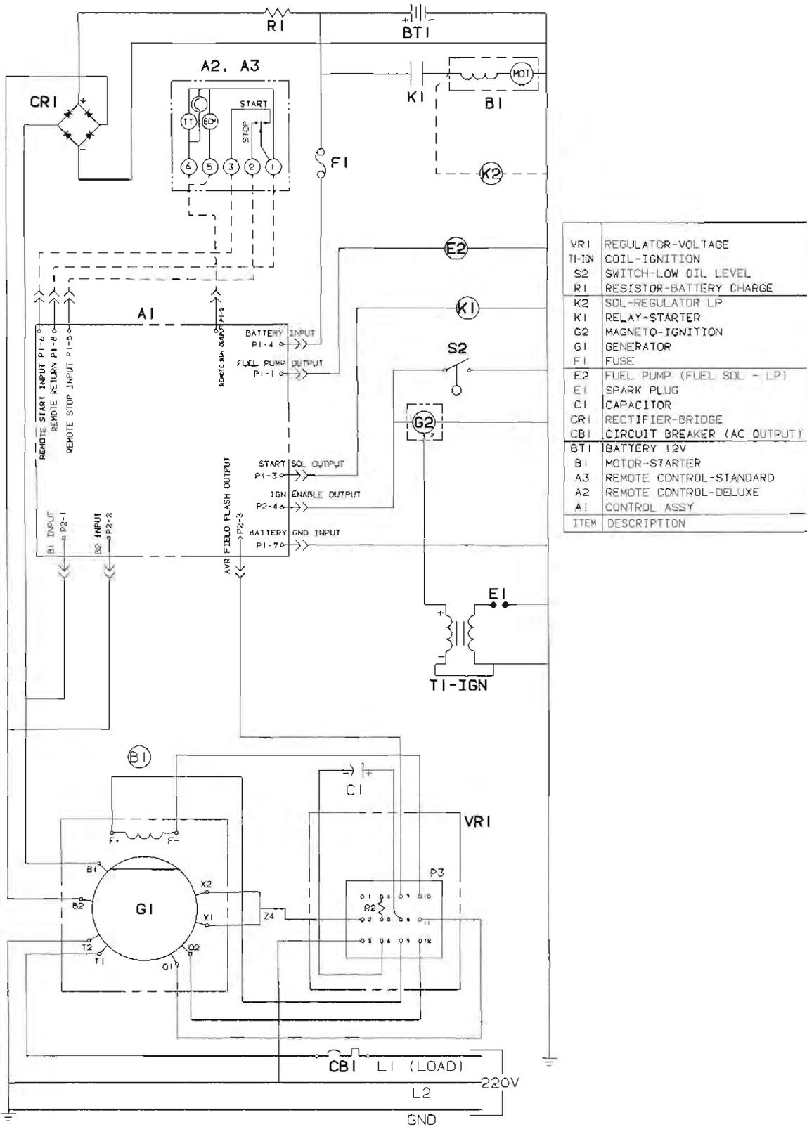
FIGURE 12-3. WIRING SCHEMATIC 610-0383
